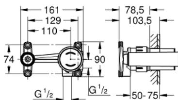
23 429 000 **СМЕСИТЕЛЬ ОДНОРЫЧАЖНЫЙ JOYSTICK DN 15, ВСТРАИВАЕМЫЙ
